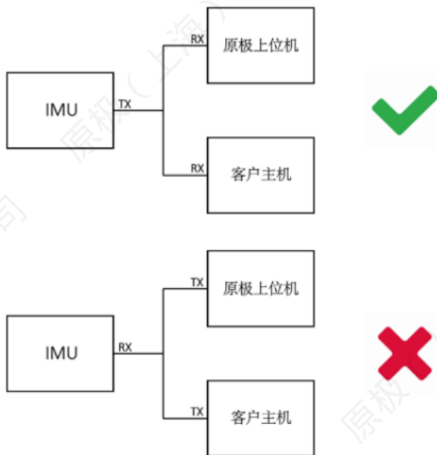
图 6 串口连接方式示意图
