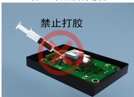
图 19 安装错误示意图
