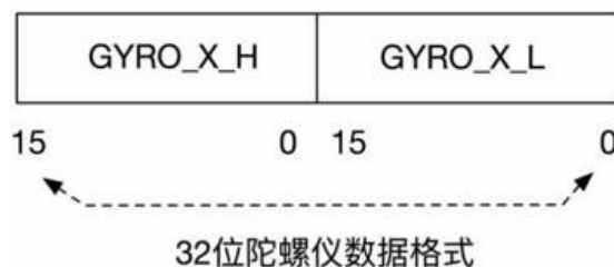
图 10 SPI32 位数据还原示意图
