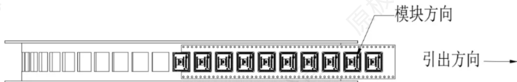
图 8 模块在载带位置和方向
