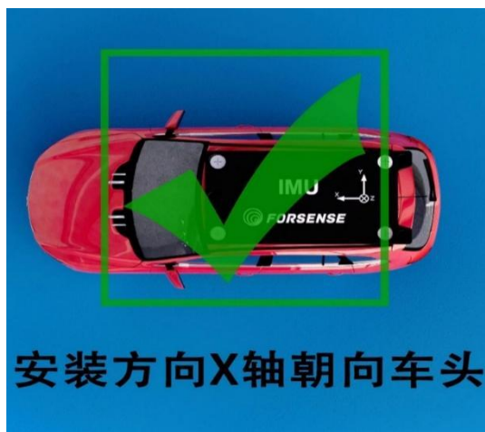
图 16 正确安装示意图
