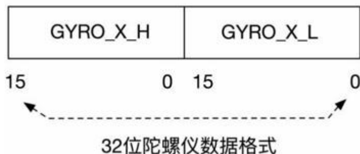
图 5 SPI32 位数据还原示意图
