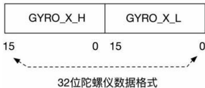
图 5 SPI32 位数据还原示意图
