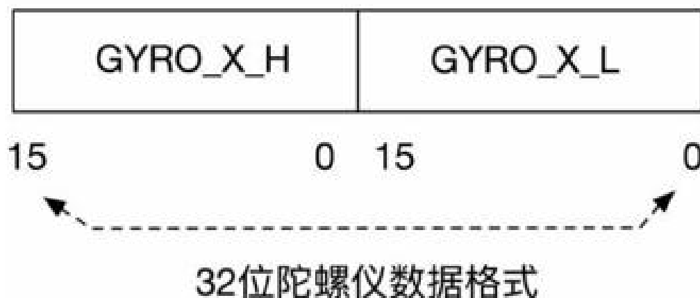
图 19 SPI32 位数据还原示意图
