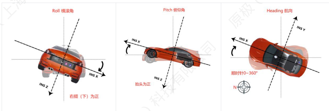
图 16 横滚、俯仰、航向角示意图
