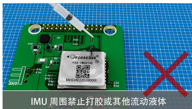
图 23 安装错误示意图
