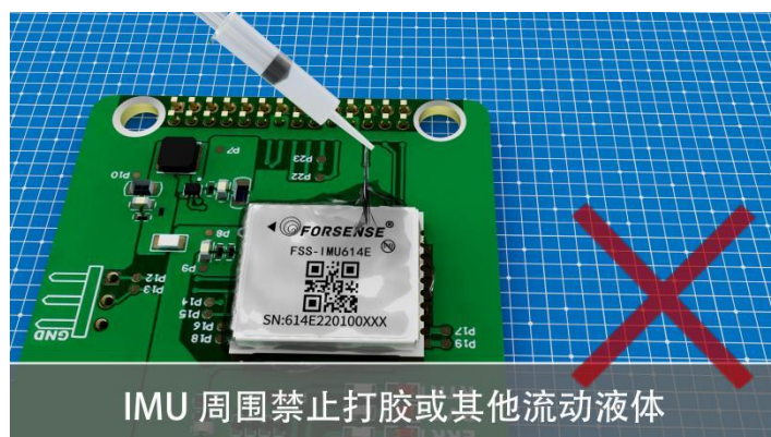
图 24 安装错误示意图
