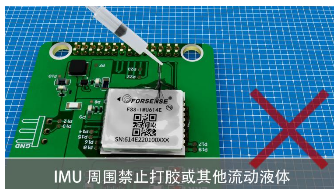
图 24 安装错误示意图
