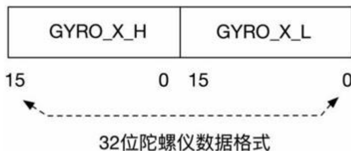
图 20 SPI32 位数据还原示意图
