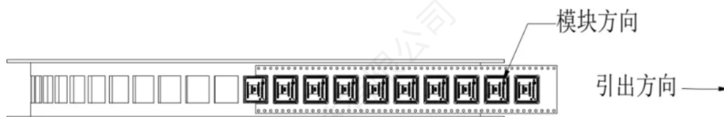
图 38 模块在载带位置和方向
