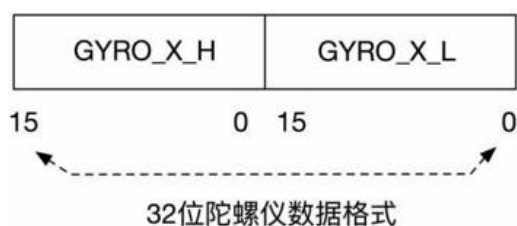
图 20 SPI32 位数据还原示意图
