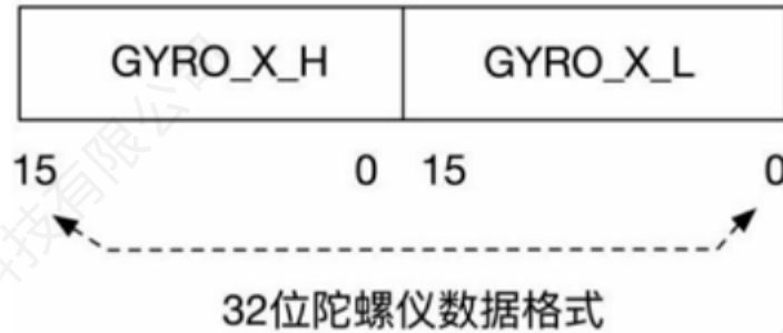
图 22 SPI32 位数据还原示意图
