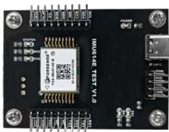
IMU614E-X 测试底板（老底板）
