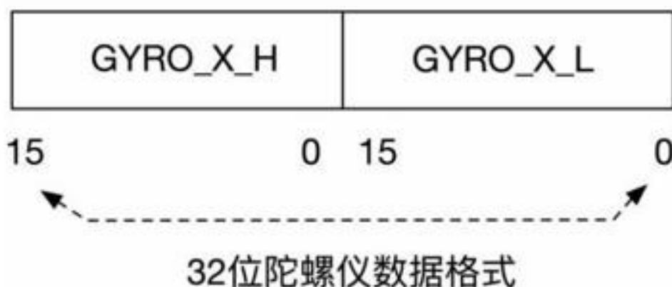
图 19 SPI32 位数据还原示意图
