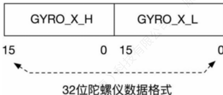
图 20 SPI32 位数据还原示意图
