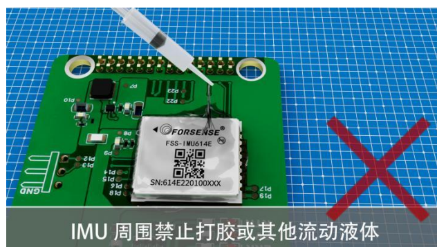
图 23 安装错误示意图
