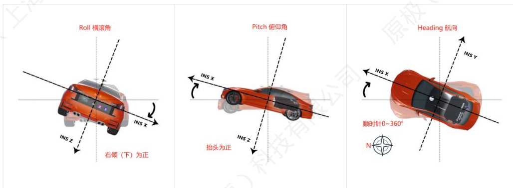
图 23 横滚、俯仰、航向角示意图
