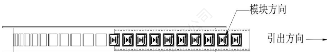
图 30 模块在载带位置和方向
