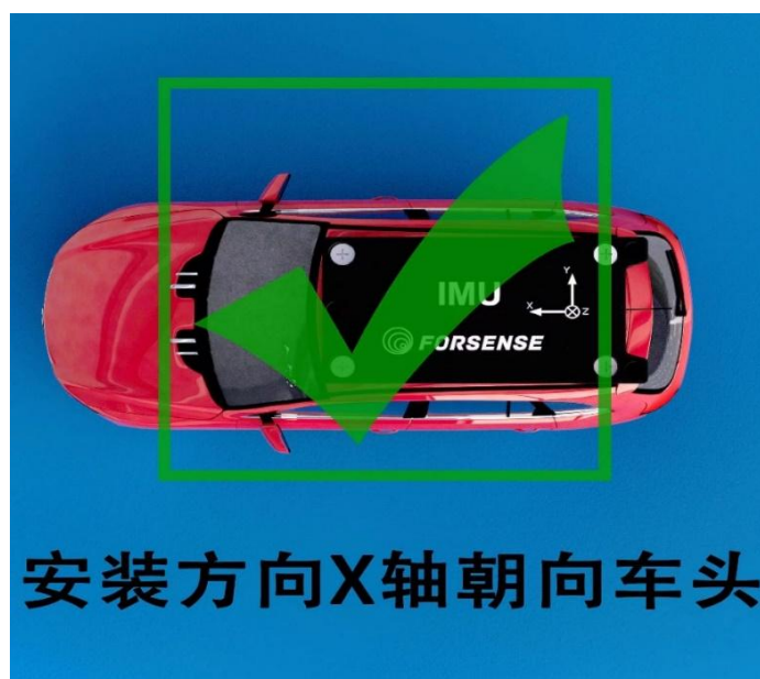
图 17 正确安装示意图
