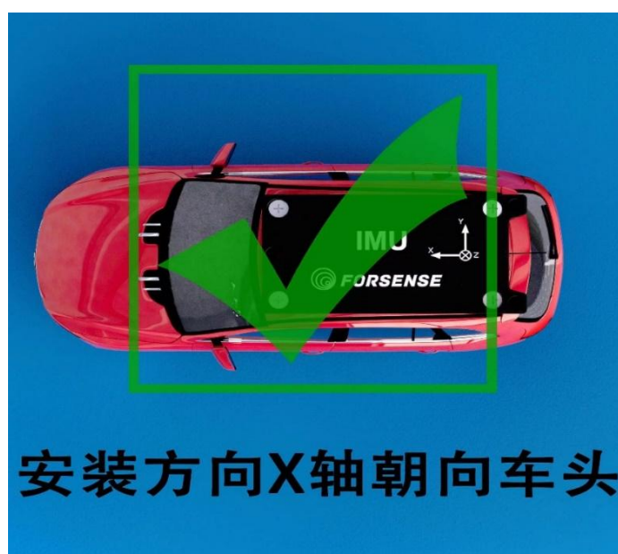
图 17 正确安装示意图
