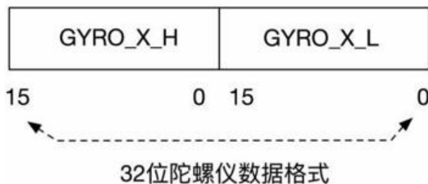
图 14 SPI 32 位数据还原示意图
