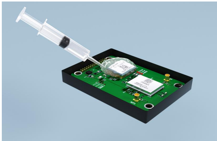
图 10 安装错误示意图
