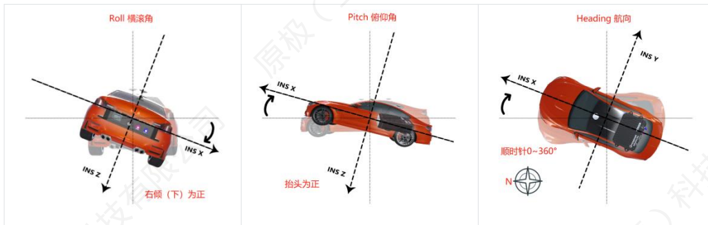
图 7 横滚、俯仰、航向角示意图
