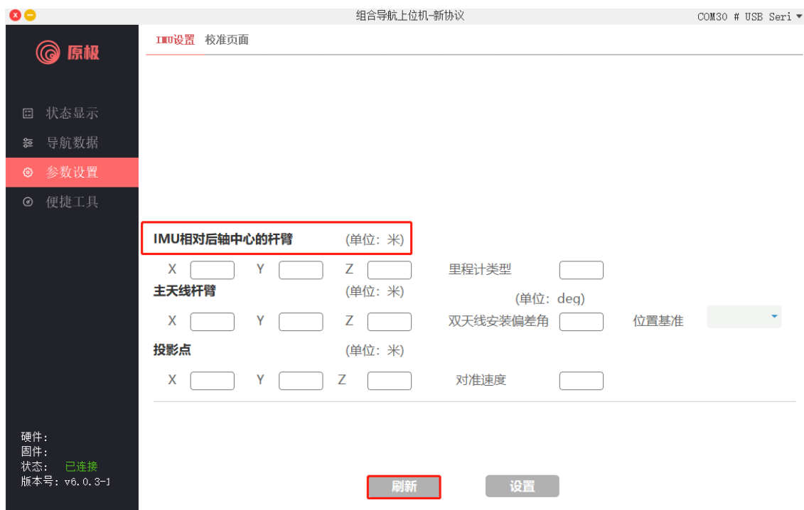
图 9 配置到后轴中心的杆臂位置
