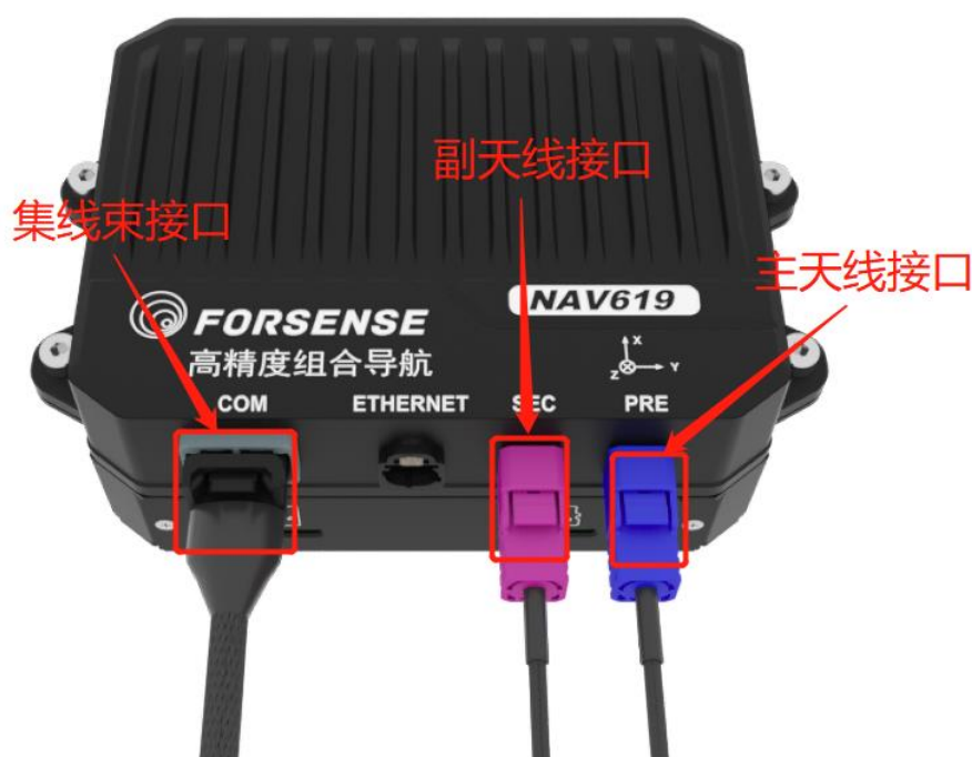
图 2 设备主机接线示意图
