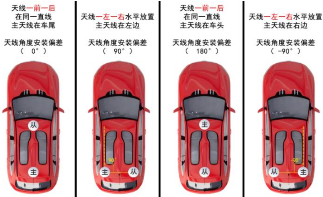
图 7 双天线安装示意图
