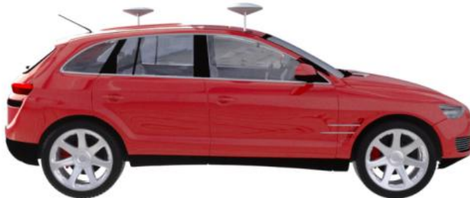
图 20 双天线安装示意图
