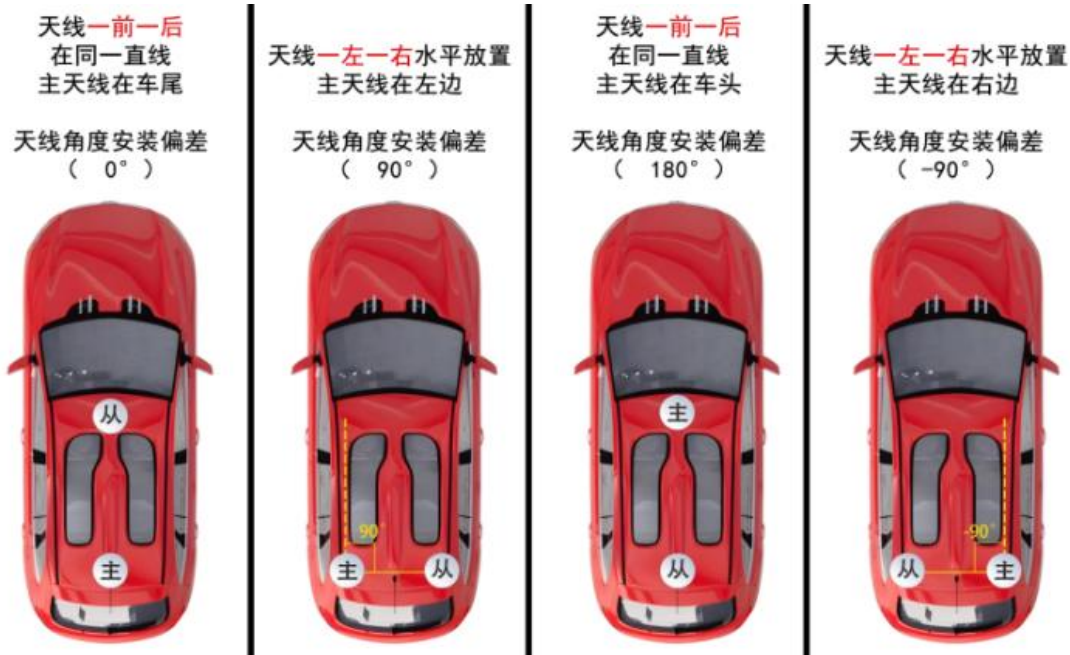
图 7 双天线安装示意图
