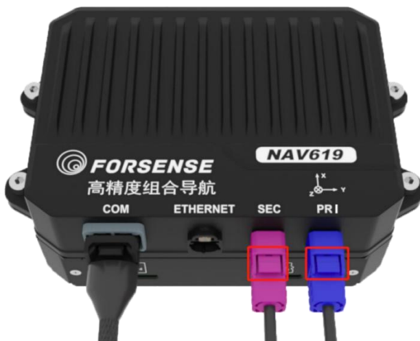
图 23 天线馈线插拔示意图
