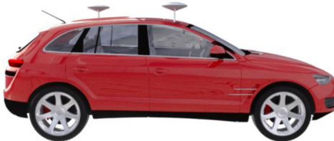
图 20 双天线安装示意图
