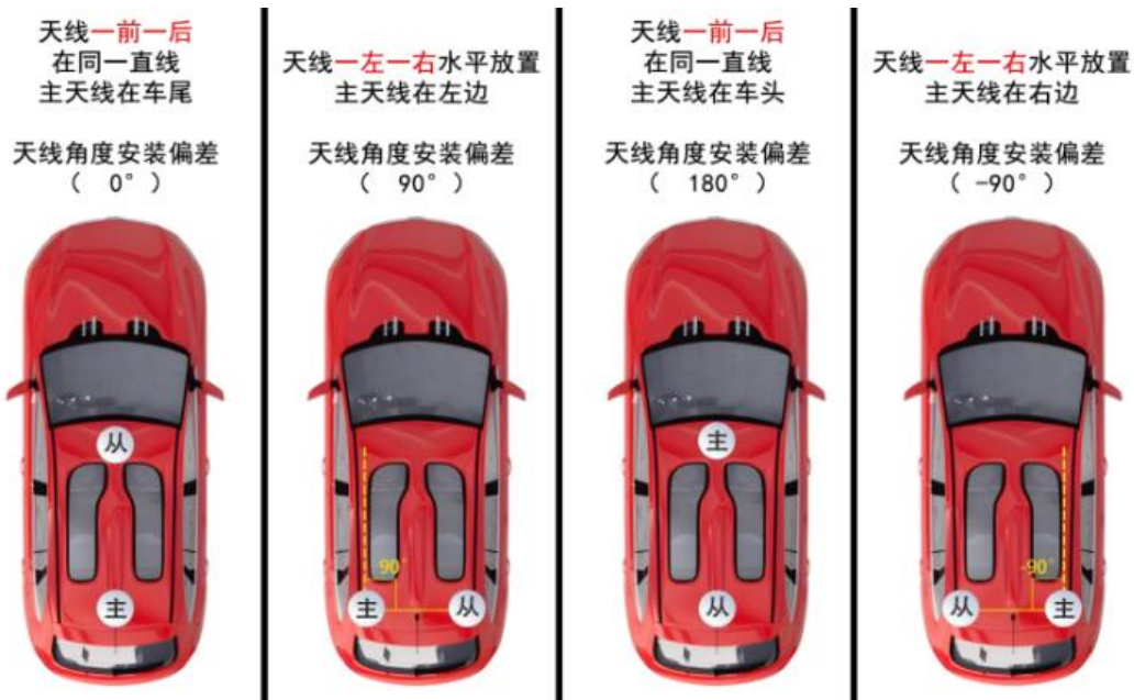
图 8 双天线安装示意图
