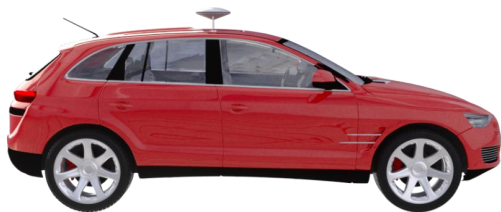
图 20 单天线安装示意图
