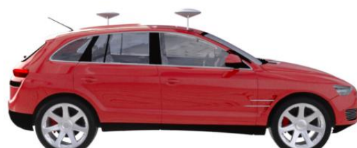
图 21 双天线安装示意图
