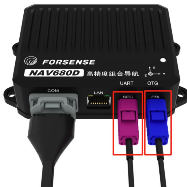
图 24 天线馈线插拔示意图
