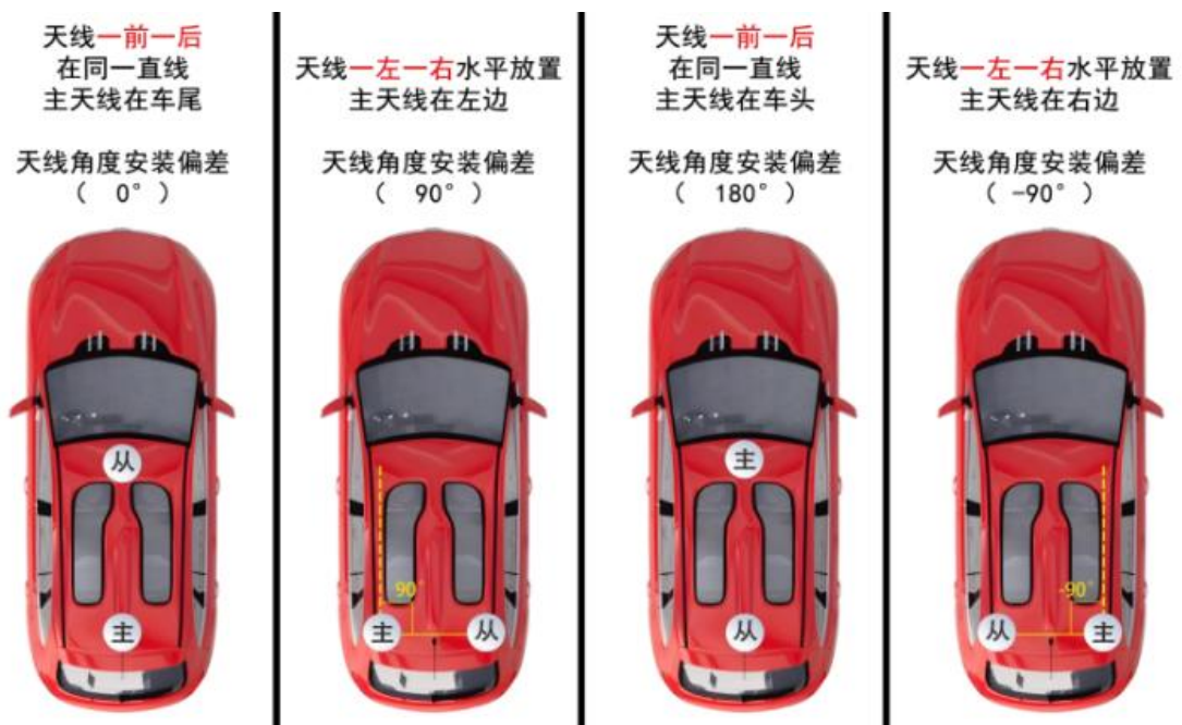
图 7 双天线安装示意图
