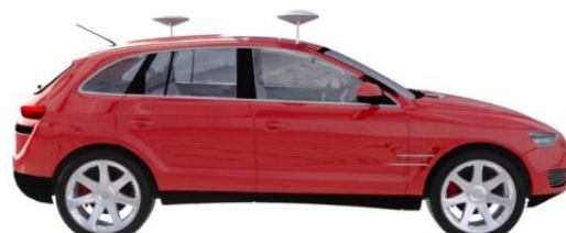
图 21 双天线安装示意图
